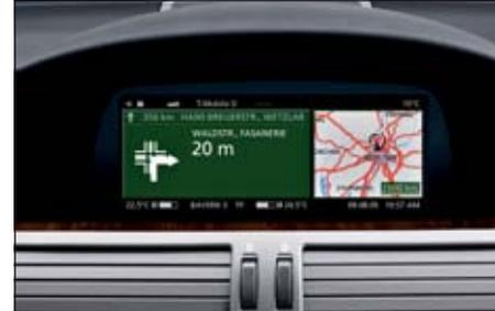
□ **Sistema di navigazione** con Control Display antiriflesso da 8,8 pollici, in abbinamento all'autoradio BMW Professional. Con un ampio archivio di dati per la navigazione, disponibile anche su DVD. Le indicazioni per la guida sono fornite da un computer vocale; ulteriori informazioni tramite frecce direzionali (sul display delle informazioni) o mappa cartografica (di serie per 760i/Li).
