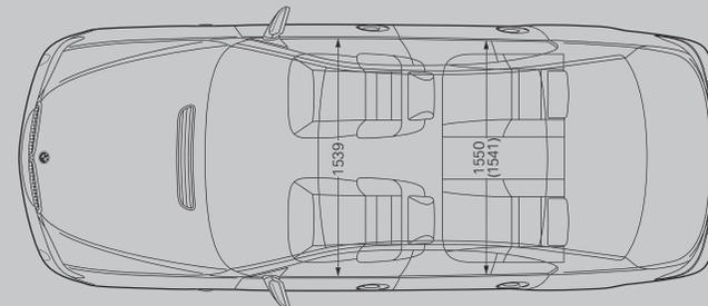
Tutte le misure dei disegni tecnici sono espresse in millimetri. Capacità del bagagliaio 500 litri (misurazione VDA). I valori in ( ) si riferiscono alle 730Li, 740Li, 750Li, 760Li e 730Ld.
