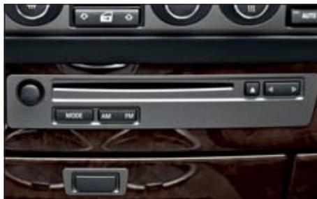
□ **Radio BMW Business CD** con antenna Diversity, adeguamento automatico del volume, inserimento/espulsione motorizzati del CD, attacco per cambia-CD BMW.
