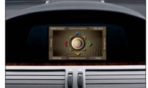
■ **Control Display** con schermo LCD da 6,5 pollici. Sul Control Display possono essere visualizzate le funzioni gestite tramite il Controller, ad esempio le informazioni del computer di bordo o le regolazioni dei programmi radio. Per migliorare al massimo la leggibilità i menu sono rappresentati con sfondi di differenti colori.
