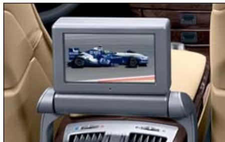
□ **Schermo posteriore.** Tramite il grande schermo 16/9 da 6,5 pollici è possibile azionare comodamente dal retro dell'abitacolo la radio, i sistemi di altoparlanti HiFi e gli optional telefono veicolare Professional e funzione TV (anche durante la marcia). La dotazione comprende anche il secondo Controller posteriore. Di serie per la versione Futura ed Eccelsa passo lungo.
