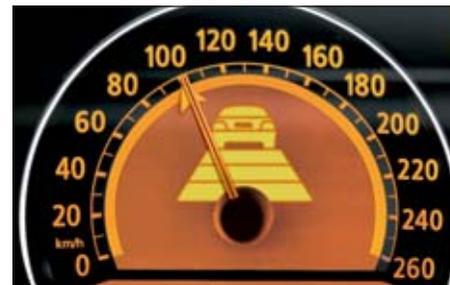
□ **Active Cruise Control:** consente di viaggiare in modo confortevole ad una velocità preselezionata. Nella marcia in colonna, la BMW Serie 7 adegua automaticamente la propria andatura alla velocità del veicolo che precede, mantenendo sempre la distanza di sicurezza preselezionata.
