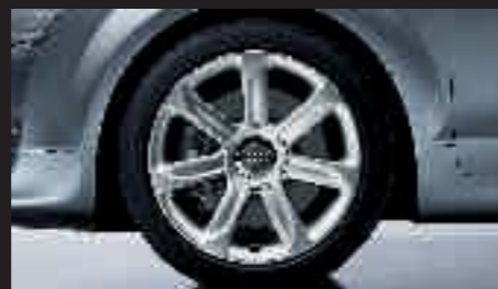
Cerchi in lega di alluminio a 7 razze, 9 J x 18 con pneumatici 245/40 R 18
