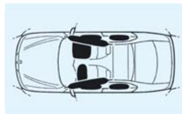
**Airbag:** in una BMW tutti i componenti di sicurezza sono armonizzati in modo ottimale. In caso di impatto, ad esempio, si attiva soltanto l'airbag effettivamente necessario. Per una protezione mirata sono disponibili 8 airbag: gli airbag anteriori (che si espandono con differente intensità a seconda della forza d'urto), gli airbag per la testa ITS e gli airbag laterali anteriori e posteriori (optional).
