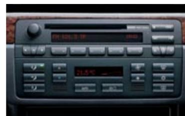
□ **BMW Professional:** dotazione come BMW Business più frequenza Diversity con 2 sintonizzatori (due ricevitori distinti cercano di continuo la ricezione più pura e commutano impercettibilmente sulla frequenza migliore), lettore di CD incorporato, inserimento/espulsione motorizzati del CD, attacco per cambia-CD BMW.
