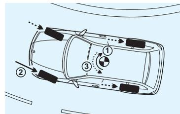
■ **Cornering Brake Control (CBC):** rende ancora più sicure e controllabili le frenate in curva, impedendo efficacemente lo sbandamento della vettura. Il CBC è coadiuvato dal sistema antibloccaggio ABS e dall'impianto frenante presoché esente da fading, che realizzano il massimo della sicurezza di marcia.
