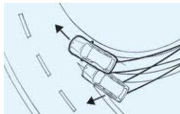
■ **Controllo dinamico di stabilità (DSC)** con DTC: il DSC individua sul nascere l'eventuale tendenza al dérapage e stabilizza l'auto in pochi millesimi di secondo. La sottofunzione DTC (controllo dinamico della trazione) consente entro limiti predeterminati un maggiore slittamento delle ruote, favorendo la guida sportiva. Il DTC si attiva con una breve pressione dell'interruttore del DSC.
