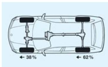
□ Il **sistema di trazione integrale BMW** unisce l'elevata trazione offerta dalla trasmissione permanente su quattro ruote motrici alla straordinaria maneggevolezza di una BMW Serie 3 (disponibile per 325i, 330i e 330d).
