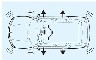
■ **Sensore d'urto:** in caso di incidente esclude la funzione Center Lock della chiusura centralizzata permettendo l'apertura delle portiere; contemporaneamente si accendono le luci interne dell'abitacolo.
