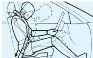
■ **Sistema di ritenzione BMW** per guidatore e passeggero: combinazione di cintura di sicurezza a 3 punti, pretensionatore, limitatore di ritenzione ed appoggio anti-submarining incorporato nel sedile che assicura la massima efficacia di ritenzione in caso di collisione.
