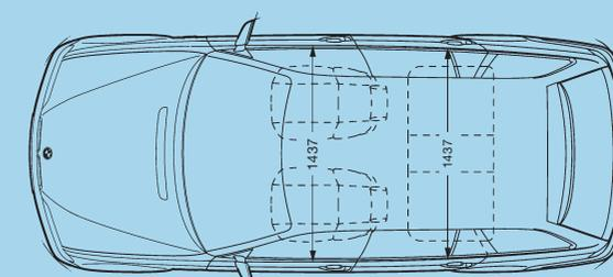
Tutte le misure dei disegni tecnici sono espresse in millimetri. I valori in ( ) si riferiscono alle 316i e 318d. I valori in [ ] si riferiscono alle vetture con trazione integrale. Capacità del vano bagagli 435-1345 litri (misurazioneVDA).
