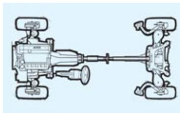
■ **Assetto a struttura leggera** con assale anteriore a snodo singolo e montanti molleggiati ed assale posteriore a bracci centrali; per realizzare un'aderenza eccellente al fondo stradale e la massima sicurezza di guida, molti componenti dell'assetto sono in alluminio.
