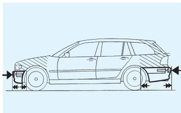
■ **Paraurti con smorzatori in alluminio ad assorbimento d'urto:** sopportano senza danni colpi fino a 4 km/h; speciali zone deformabili anteriori e posteriori assorbono forze d'urto fino a 15 km/h senza danni per la carrozzeria.
