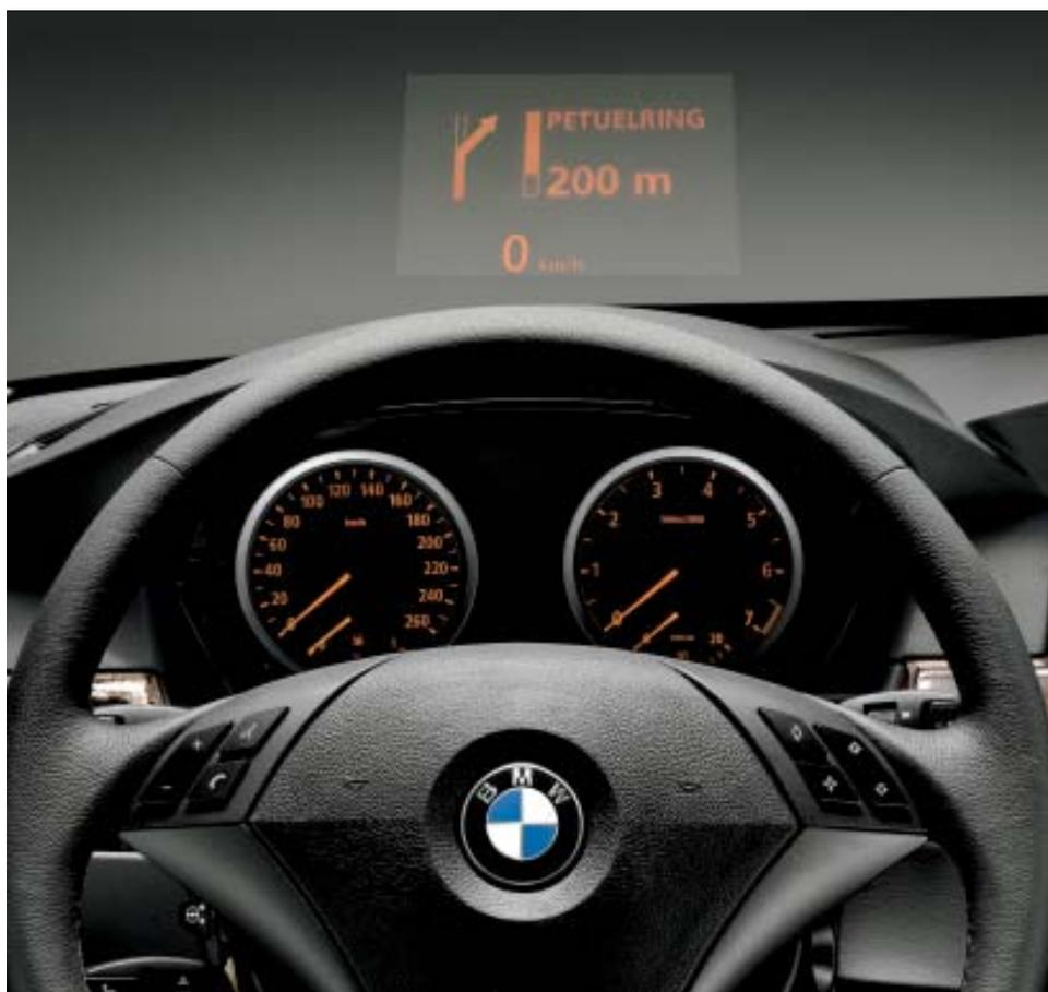
□ **Head-Up Display:** fornisce al guidatore, direttamente nel suo campo visivo, informazioni importanti per la guida, come ad esempio la velocità momentanea. Sono inoltre visualizzabili le frecce direzionali della navigazione nonché le funzioni dell'Active Cruise Control e del Check Control.
