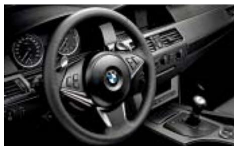
□ **Cambio manuale sequenziale (SMG):** consente di innestare i sei rapporti in modo veloce e sportivo mediante le levette sul volante o la leva selettiva, senza l'uso della frizione. Con il Dynamic Drive Control (modalità sportiva) selezionabile mediante un tasto si ottiene tra l'altro una risposta più pronta del motore. Sono stati inoltre ottimizzati i tempi d'innesto della frizione e delle marce (optional per 530i e 550i).
