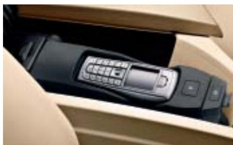
□ **Predisposizione per cellulare con interfaccia Bluetooth<sup>1</sup>.** Tramite un adattatore Snap-In disponibile separatamente è possibile collegare un telefono cellulare predisposto per Bluetooth, azionabile tramite volante multifunzionale o voice control. Il vostro Concessionario BMW o la vostra Filiale BMW vi informerà volentieri sui modelli di telefoni consigliati.
