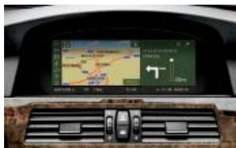
□ **Sistema di navigazione Professional** con schermo a colori da 8,8 pollici. Le indicazioni per la guida sono fornite tramite annunci vocali e frecce direzionali o mappa cartografica. Con la funzione splitscreen è possibile suddividere il quadro dello schermo per visualizzare contemporaneamente ad esempio la radio e la navigazione. Di serie per la versione Attiva, Futura Msport ed Eccelsa.
