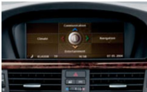
□ **Sistema di navigazione Professional** (con ricezione a 2 sintonizzatori, lettore CD e DVD, Controller dell'iDrive) e display grafico da 8,8 pollici ad alta risoluzione con visualizzazione mediante mappa grafica e frecce direzionali.
