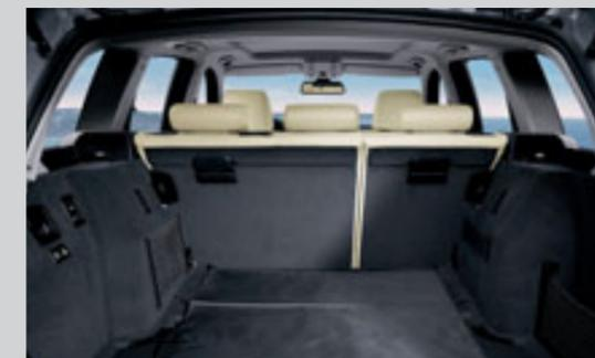
L'equipaggiamento del bagagliaio comprende inoltre il fondo double-face. Il telo protettivo incorporato evita che il piano di carico si sporchi e si può anche stendere sopra i paraurti per proteggere la vernice durante le operazioni di carico e scarico.
