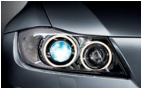
□ **Fari allo xeno anabbaglianti ed abbaglianti, con quattro anelli luminosi per le luci di posizione** e regolazione automatica della profondità: migliorano nettamente l'illuminazione della carreggiata di notte, in caso di maltempo o cattiva visibilità.
