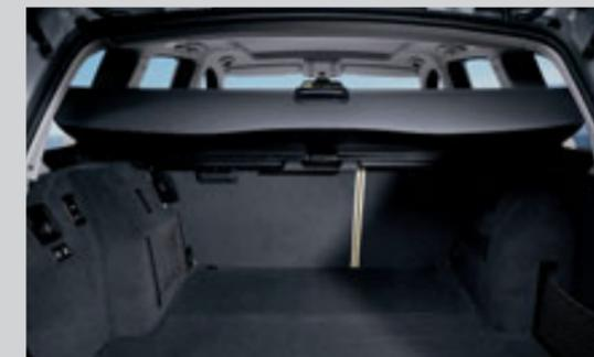
Aprendo il lunotto o il portellone posteriore, la copertura avvolgibile si solleva contemporaneamente nella sua guida. Ciò avviene automaticamente con il lunotto e a scelta con il portellone.
