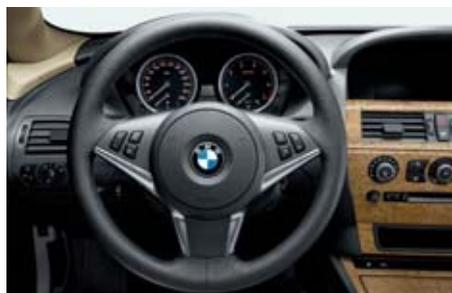
■ **Volante sportivo in pelle** a tre razze, con tasti multifunzionali incorporati mediante i quali è possibile gestire durante la marcia la radio, il lettore CD e il telefono (optional) senza staccare le mani dal volante. Due tasti sono programmabili a piacere.
