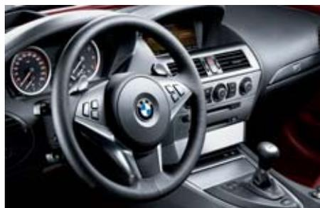
□ **Cambio manuale sequenziale (SMG)**: consente di innestare i sei rapporti in modo veloce e sportivo mediante le levette sul volante o la leva selettiva, senza l'uso della frizione.
