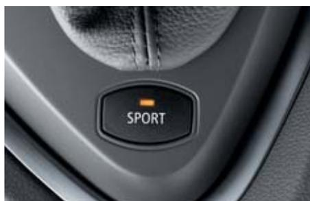
■ **Drive Dynamic Control (DDC)**, modalità sportiva attivabile con un tasto. Il motore risponde in modo ancora più immediato all'acceleratore. Nelle vetture con cambio automatico si inserisce il programma sportivo; con SMG si riducono i tempi d'innesto. Diminuisce inoltre l'azione del servosterzo, per cui migliora la percezione della strada, ed il regolatore di velocità accelera più rapidamente.
