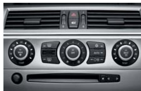
■ **Climatizzatore automatico**, con controllo automatico del ricircolo d'aria (AUC), sensore solare e sensore appannamento, regolazione automatica della temperatura (separata per guidatore e passeggero) e regolazione della quantità d'aria; indicazioni e regolazioni tramite il Control Display.
