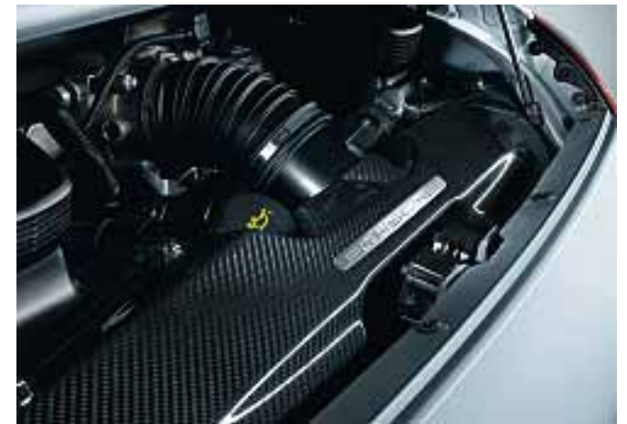
Copertura filtro aria in carbonio
